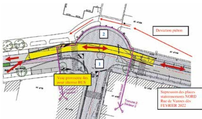
*Plan de circulation au niveau du carrefour de la rue du Général de Gaulle avec les rues de Keranna et de Vannes pendant les travaux de la voirie hors rénovation du réseau des EU.*
